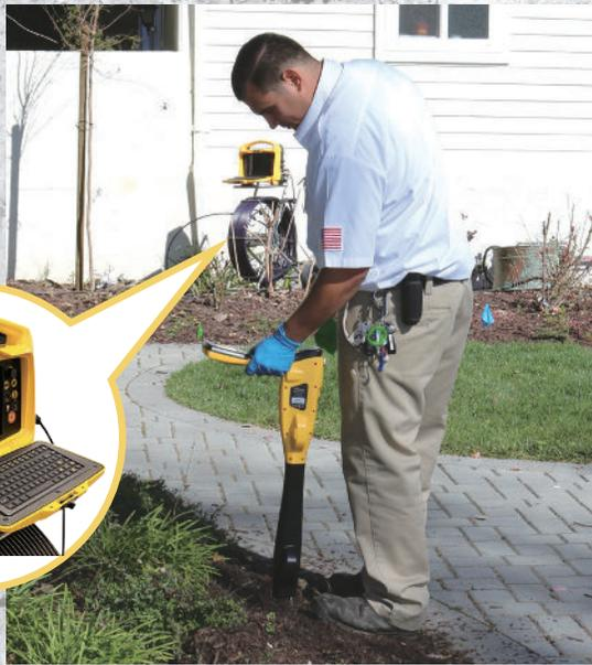
vLoc3-Cam Sonde Locator
